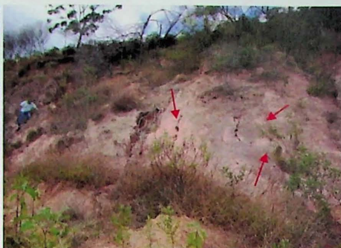
Fig. 7.2 – Sulcos erosivos no material escorregado.
