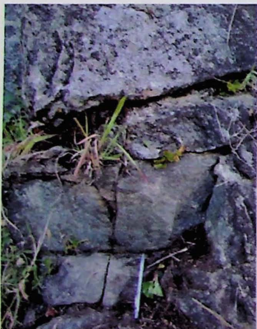
Fig. 2.1 – Detalhe dos blocos formados pela intersecção de fraturas.
